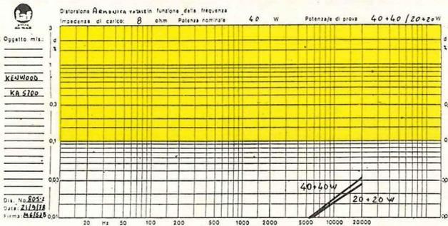
2b - Distorsione armonica totale in funzione della frequenza a 40+40 W e 20+20 W. Canale sinistro. Canale destro praticamente coincidente.
