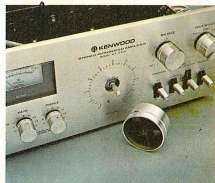
A sinistra vediamo tra gli altri interruttori quello del doppio tape monitor e quello del dubbing che permette il riversamento del segnale dall'ingresso A a quello B. A destra, l'interno della manopola del volume: l'anima è in plastica con rivestimento in alluminio.
