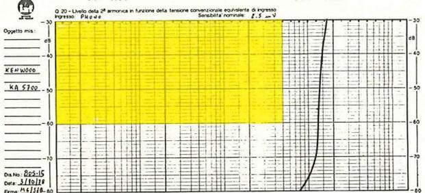
9d - Q 20. 2ª armonica della fondamentale del segnale di prova in funzione della tensione equivalente in ingresso. Attenzioni in dB riferite al livello della fondamentale. Canale sinistro. Canale destro praticamente coincidente.
