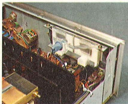
A sinistra vediamo le morsettiere per il collegamento dei diffusori; il sistema di fissaggio a vite, per quanto un po' scomodo, risulta estremamente efficace. A destra, il sistema di illuminazione degli strumenti; ad apparecchio acceso risulta illuminato anche l'interno dell'amplificatore. Sotto, i « minuscoli » potenziometri del volume e del bilanciamento.
